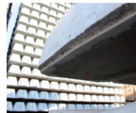
Traverses en béton équipées de semelles pour ménager l'assiette de la voie
