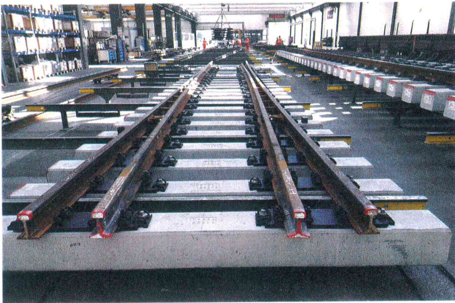
Bild 4: Weichenabbund im BTC Hägendorf, Herrliberg-Feldmeilen-Weiche 15, August 2018
