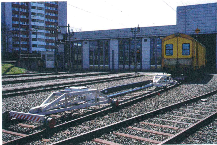
Bild 1: Einsenkungsmesswagen der Firma InfraMT (Schweiz), Belastungswagen (gelb) und angehängtes Einsenkungsmesssystem
