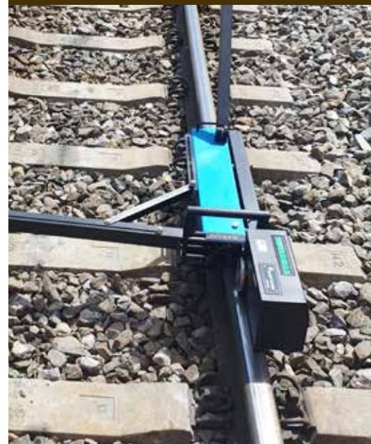
Mesure du coefficient de frottement à l'aide d'un tribomètre (photo MGB, Ivan Escher)
