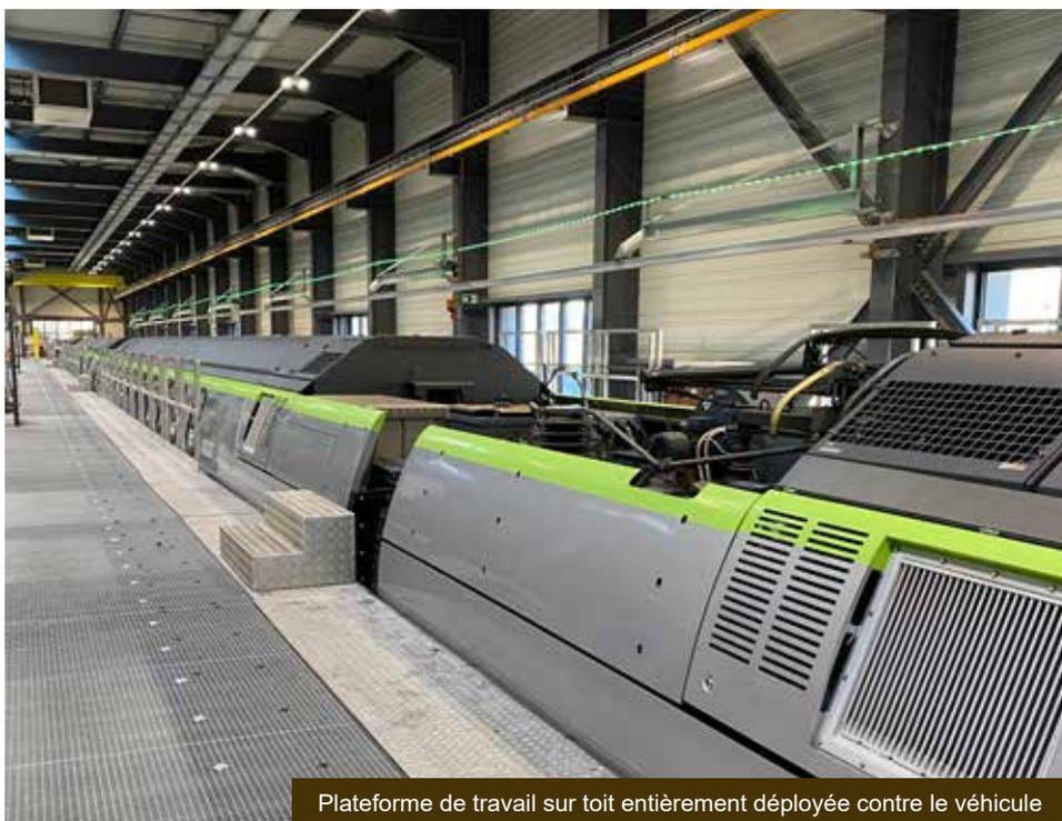
Plateforme de travail sur toit entièrement déployée contre le véhicule
